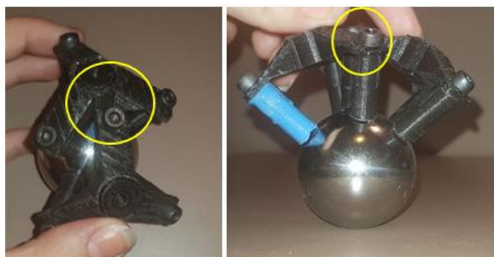
Ilustración 42. Colisiones primer prototipo tridente
