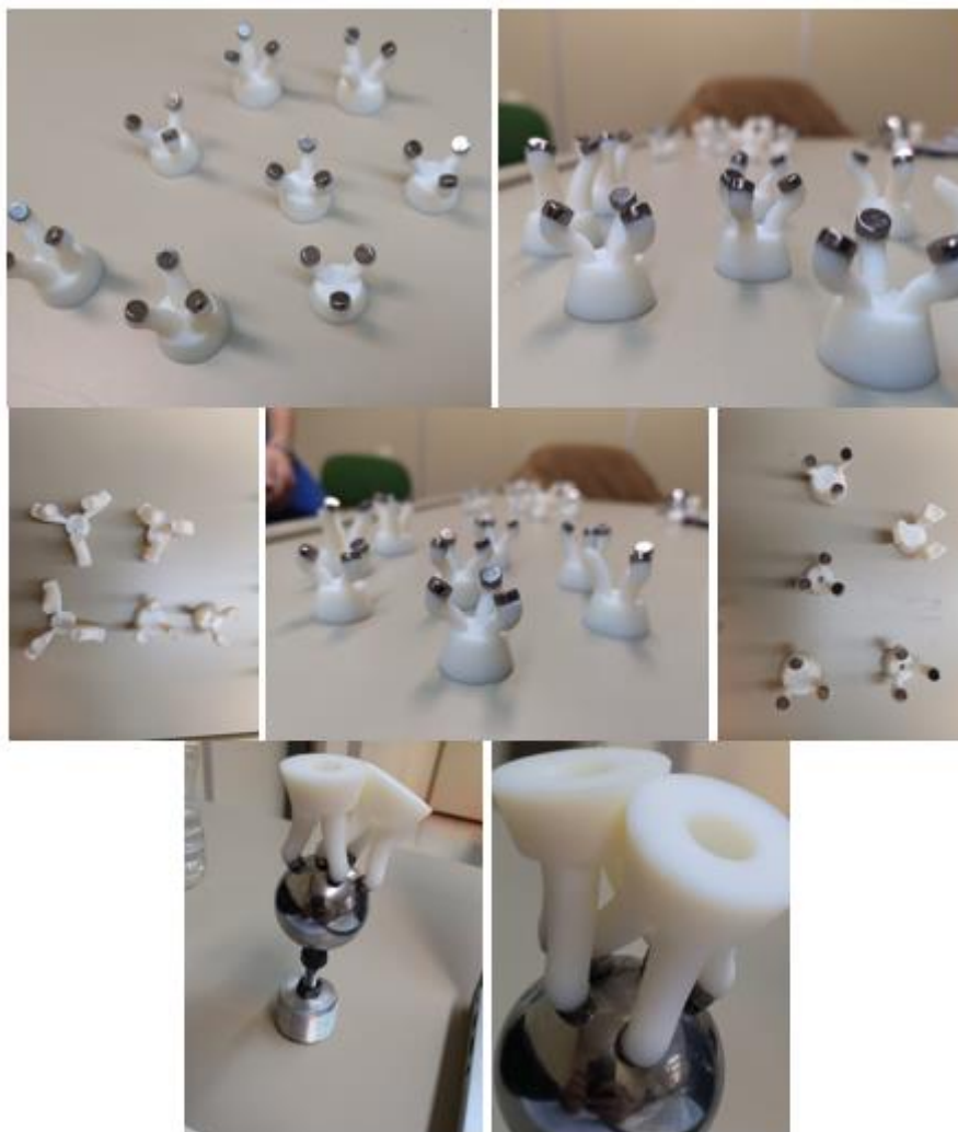
Ilustración 55. Mejores tridentes impresos en Objet 3D
