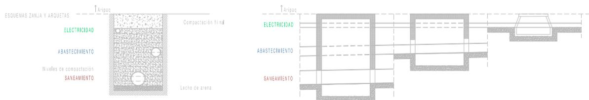
Las redes comparten la misma zanja pero respetan las distancias mínimas estipuladas entre instalaciones que pueden tener efectos sobre otras. Agua sanitaria circula por encima de saneamiento y electricidad por encima de agua sanitaria con una distancia de 30 cm. El esquema de corte por arquetas presentado anteriormente muestra como cada una de las arquetas tienen lugar permitiendo el paso de las instalaciones de igual modo por una lado o por el otro de la misma.
