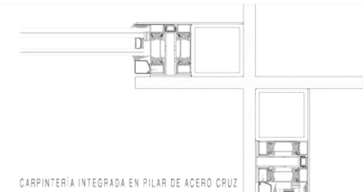
CARPINTERÍA INTEGRADA EN PILAR DE ACERO CRUZ
