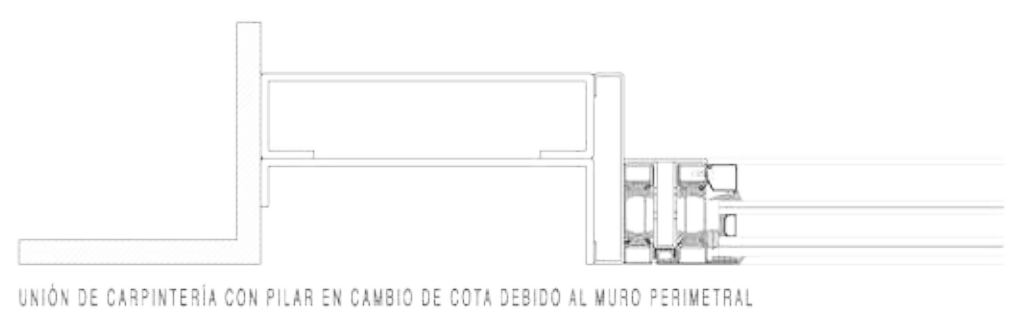
UNIÓN DE CARPINTERÍA CON PILAR EN CAMBIO DE COTA DEBIDO AL MURO PERIMETRAL
