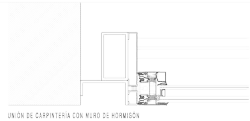
UNIÓN DE CARPINTERÍA CON MURO DE HORMIGÓN
