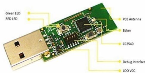
Fig. 2.3. Dispositivo CC2540 USB Dongle de Texas Instruments
