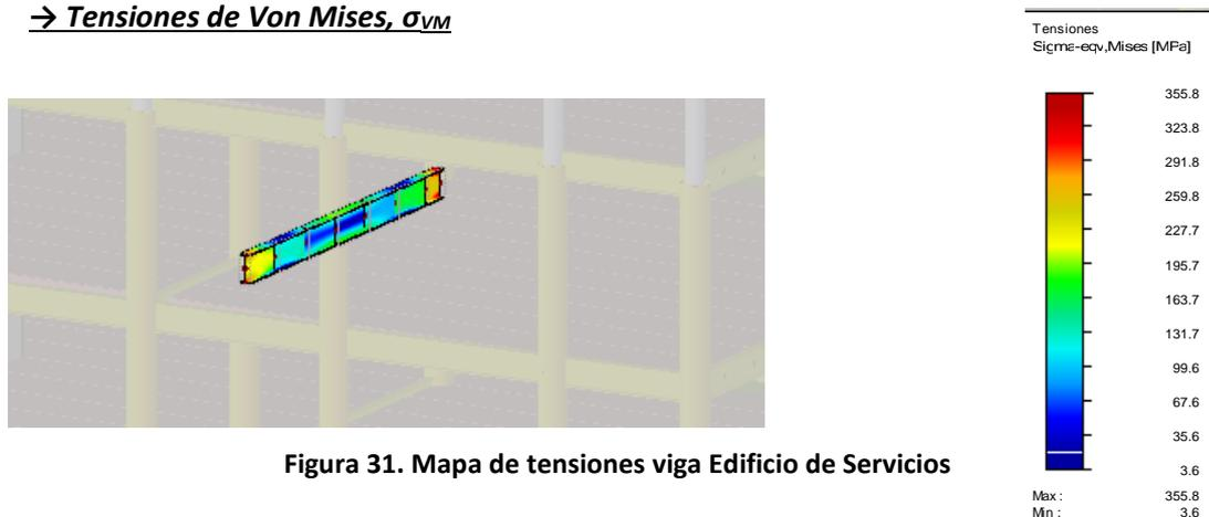
Figura 31. Mapa de tensiones viga Edificio de Servicios
