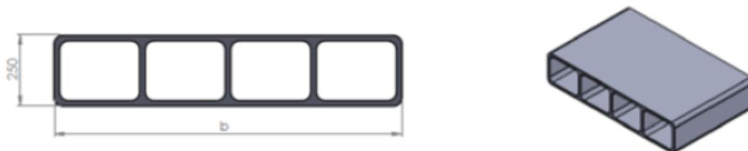
Figura 4. Sección Losas Alveolares
