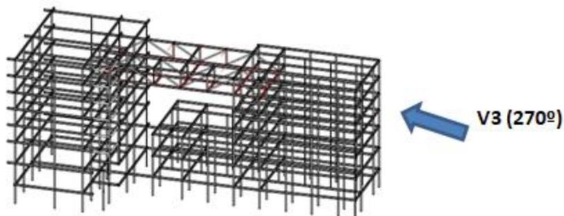
Figura 5. Viento otro lateral edificio de servicios
