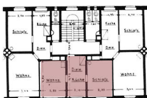
Fig. 17- Dreispänner para viudas. Marcada en rojo la vivienda que no posee ventilación cruzada
