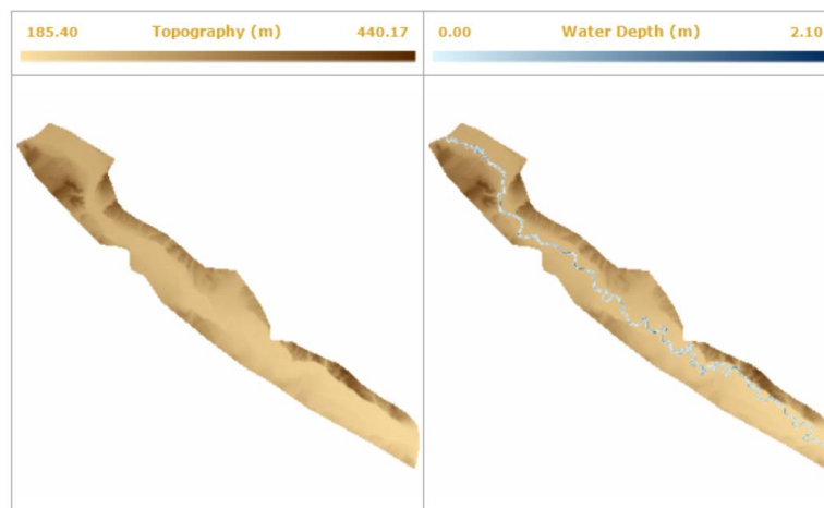
Figura D.25: Mapa 2D de la extensión de la lámina de agua sobre el MDT en el caso 3, para un caudal de 100 m 3 /s.
