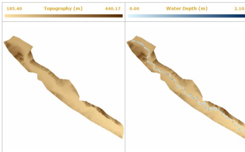
Figura 3.4: Mapa 2D de la extensión de la lámina de agua sobre el MDT en el tiempo final de la simulación para un hidrograma de caudal pico 100\text{m}^3/\text{s} y duración 20 días.
