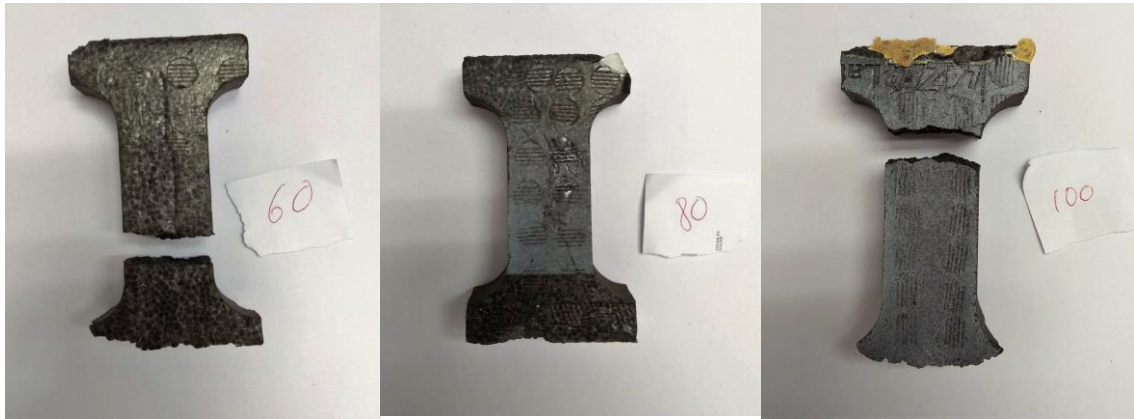
Figura 31. Modelo 2 de probetas en densidades de 60, 80 y 100 kg/m 3 tras el ensayo de tracción.
