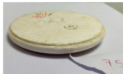
Figura 33. Probeta de densidad 75 kg/m 3 tras el ensayo de compresión.
