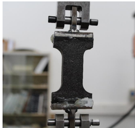
Figura 16. Amarre del ensayo de tracción.
