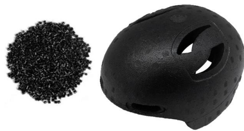
Figura 9. Estructura de un casco de poliestireno expandido
