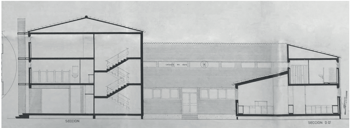
Sección transversal por patio de servicio.
