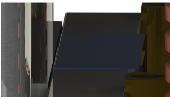
Ilustración 13. Tubo en U colocado en la baqueta para plegar
