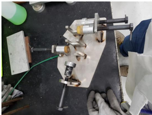
Ilustración 62. Utillaje de control de estanqueidad.
