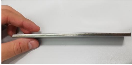
Ilustración 17. Vista del tubo de refrigeración de gases desde el cordón.
