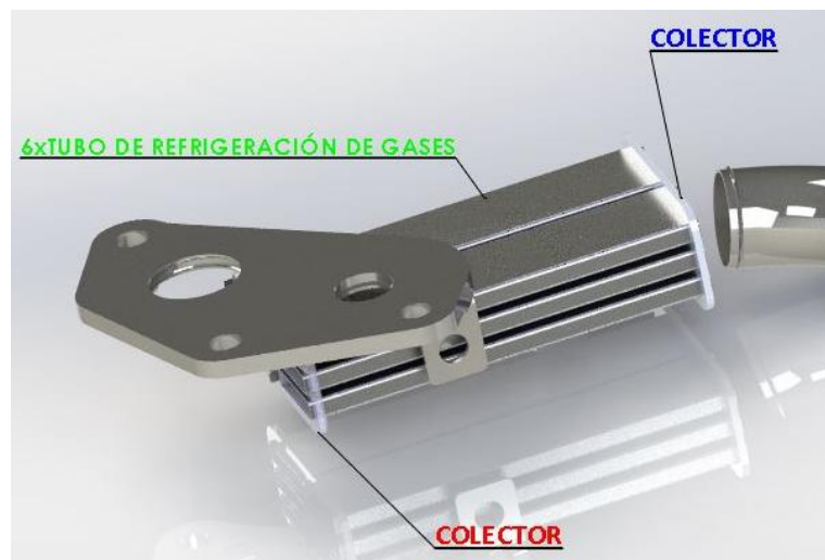
Ilustración 5. Esquema de componentes interiores al prototipo
