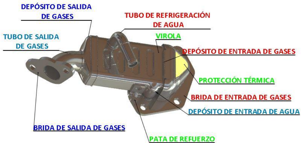
Ilustración 4. Esquema de componentes exteriores del prototipo
