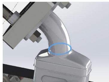
Ilustración 58. Zonas de soldeo láser para fase 4.
