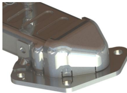
Ilustración 60. Detalle de resultado de soldeo de pata de refuerzo y protección térmica.
