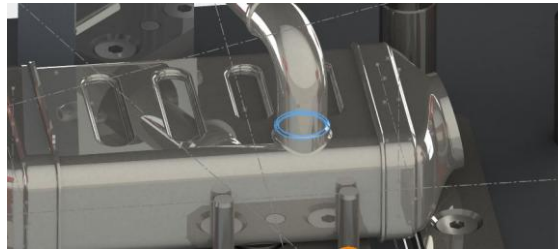
Ilustración 55. Zonas de soldeo láser de tubo de refrigeración de agua.
