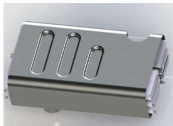
Ilustración 39. Adición de virola sobre colector y tubos.
