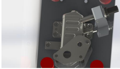
Ilustración LXXXIV. Posición lista para soldar brida de entrada de gases.
