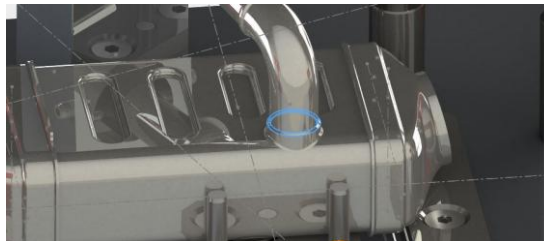
Ilustración LXXXVIII. Zonas de soldadura del tubo de refrigeración de agua.
