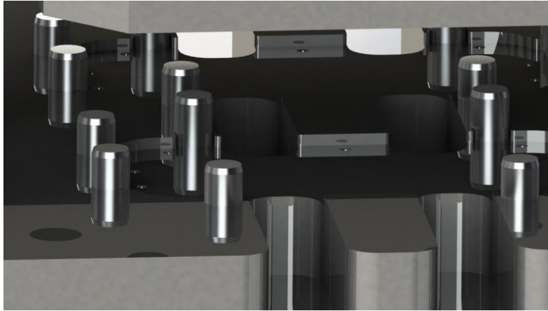
Ilustración XVIII. Detalle de hembra con forma de colector y protuberancias.
