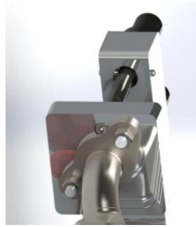
Ilustración XCIII. Posicionado de brida y tubo de salida de gases con la fase 4.
