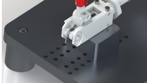
Ilustración CII. Detalle de regulación de posición de la clampa del utillaje.
