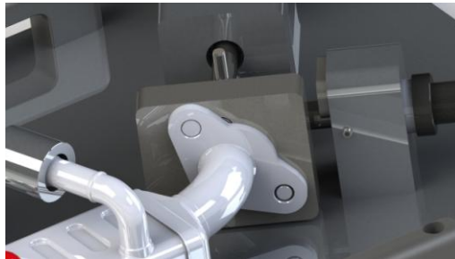
Ilustración CXII. Detalle colocación de brida de gases sobre registros.
