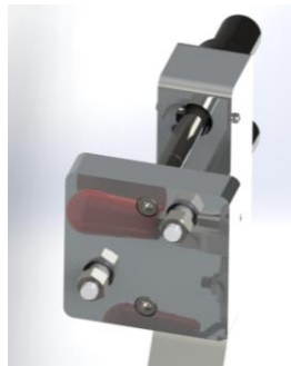
Ilustración XCIV. Detalle de sistema de posicionamiento de brida de salida de gases.
