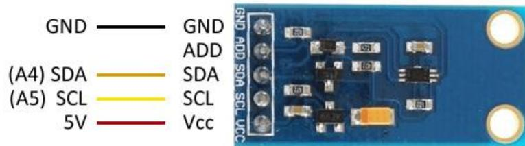
Imagen 16 Placa base de un sensor luxómetro BH1750 con detalla del funcionamiento de sus pines. Fuente, <https://www.luisllamas.es>.
