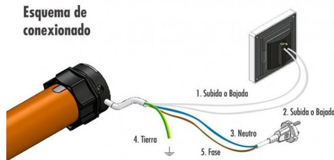
Imagen 21 Diagrama de conexionado de un motor tubular genérico. Fuente <http://www.fmautomatismos.com>.
