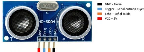
Imagen 19 Ejemplo de encapsulado de un sensor ultrasónico con el detalle de los pines de conexión. Fuente <https://cbtis140clubdeciencias.blogspot.com>
