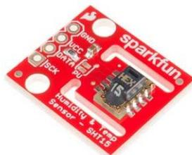
Imagen 14 Encapsulado del sensor SHT15 junto con una placa para facilitar la conexión de este sensor. Fuente, [www.sparkfun.com](http://www.sparkfun.com), tienda de electrónica.
