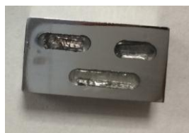
Figura 19. Portamuestras para realizar el ensayo de microdureza y análisis en SEM.
