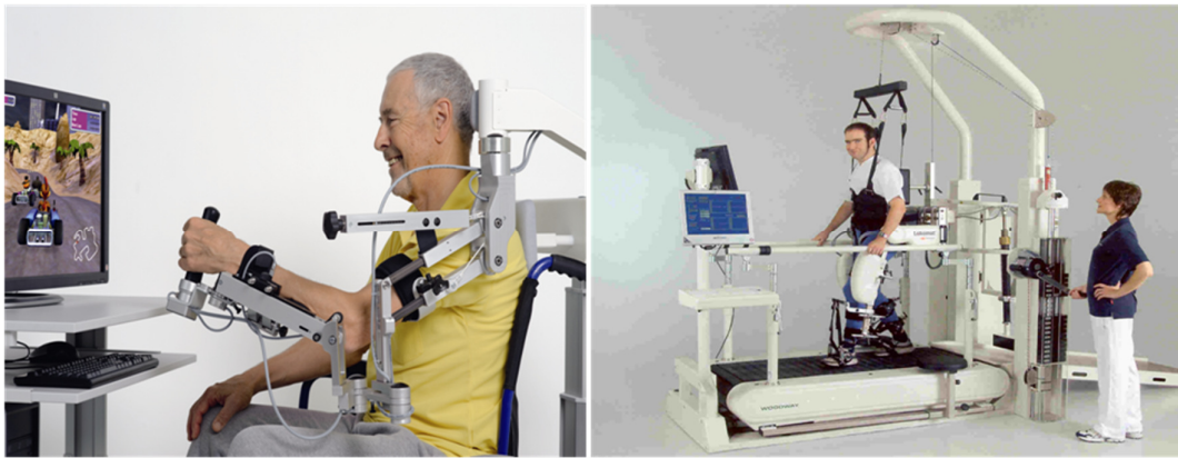
Figura 2. Se muestran dos de los dispositivos más destacados de rehabilitación. A la izquierda: ARMEO, exoesqueleto para la rehabilitación motora de la extremidad superior que combina un soporte de brazo ajustable con feedback aumentado. A la derecha: LOKOMAT, dispositivo robótico para una terapia funcional de locomoción mejorada, con feedback aumentado.
