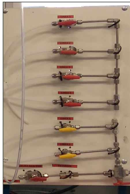
Figura 45. Llaves de paso de las líneas.
