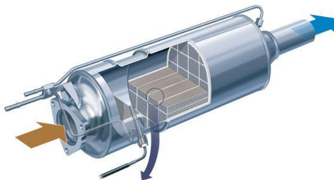
Figura 3. Filtro antipartículas de un coche diésel. [8]
