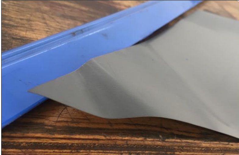
Figura 23. Chapa marcada por el Sistema de guiado
