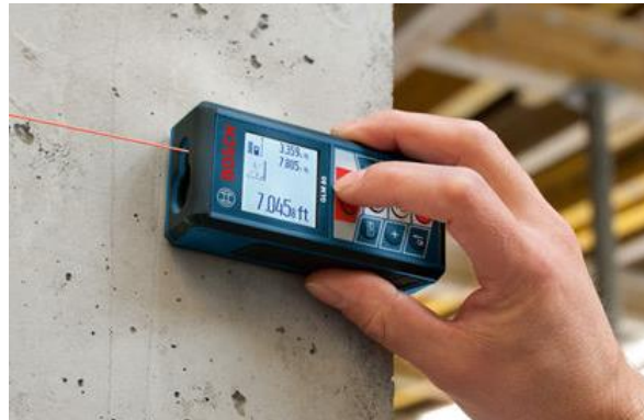
Figura 5.7. Distómetro laser haciendo una medición como las hechas por nosotros para el estudio de exactitud.
