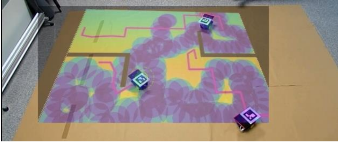
Figura 6.1. Sistema multi-robot usado por mi compañero Carlos Rubio en su TFM de nombre "Sistema multi-robot para cobertura persistente"
