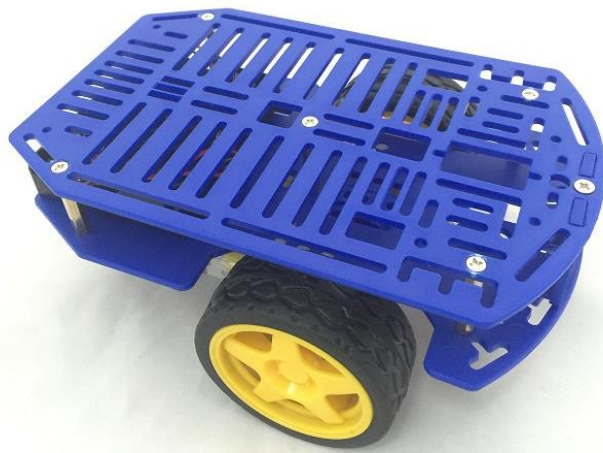
Figura 1.3. Chasis de la estructura donde se puede observar las dos placas que sirven como cuerpo principal unidas por tornillos y agujereadas ambas para dejar pasar entre ellas los distintos cables del conjunto Pi Robot
