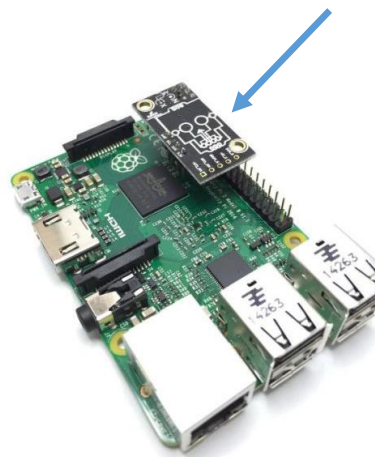
Figura 1.2. Colocación de la IMU en los puertos de la Raspberry Pi. La IMU se coloca en los 6 primeros puertos.
