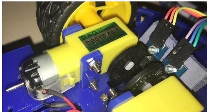
Figura A.1. Colocación del sensor del encoder y de los discos medidores
