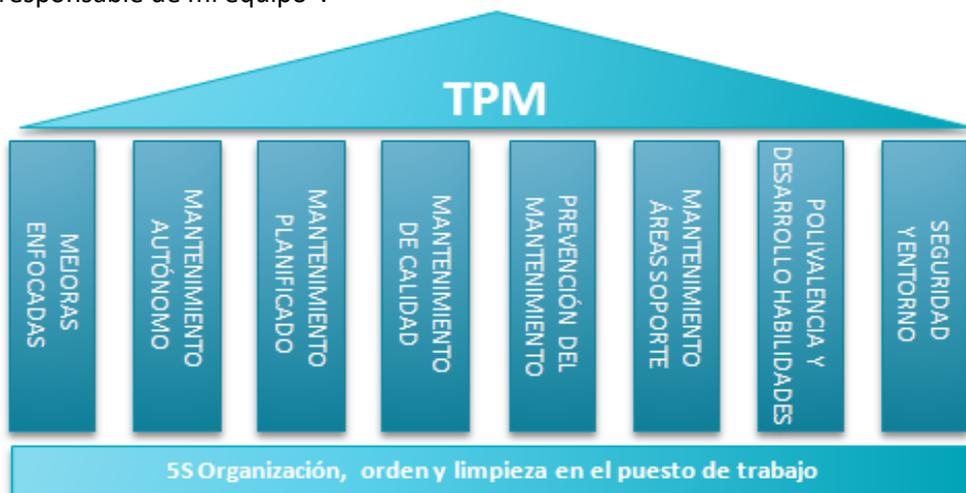
Figura 3. Pilares fundamentales del TPM.
