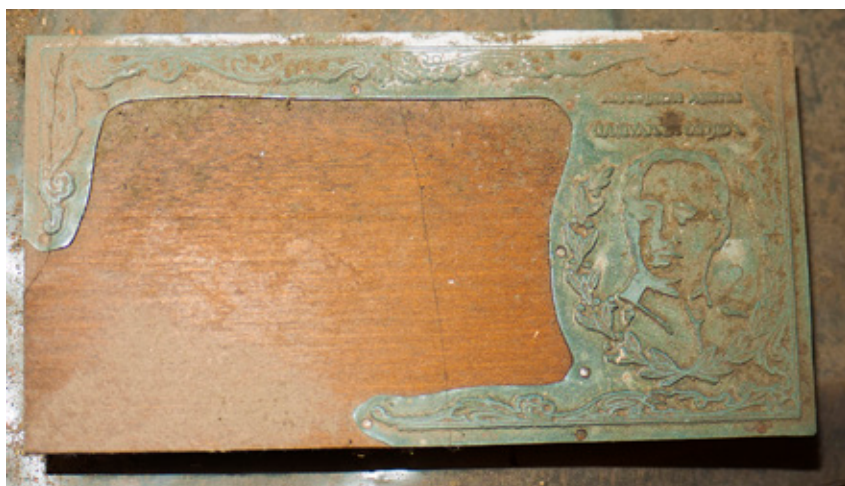
Fig. 7. Molde realizado en estereotipia preparado par servir de marco decorativo a una composición tipográfica realizado en Imprenta Blasco.
