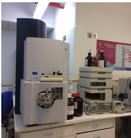
Figura 9. Equipo de HPLC-ESI-MS/MS(QTOF) utilizado para el desarrollo y la validación del método analítico de determinación de CTOs.
