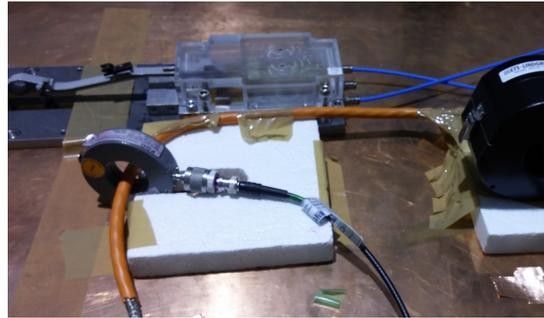
Figura 5.40: Cable de inyección paralelo al sensor
