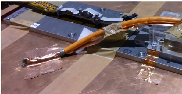
Figura 5.43: Sensor apantallado sólo por debajo del cable de inyección
