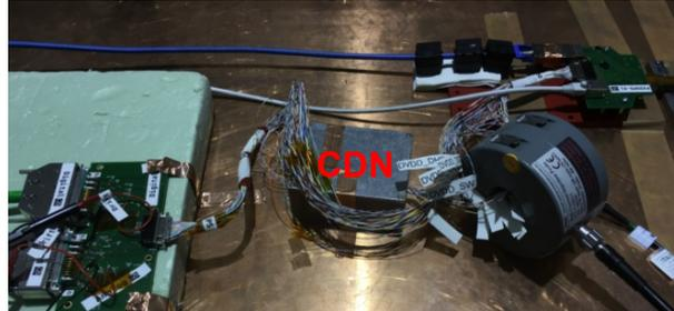
Figura 3.47: Configuración de medida con CDN
