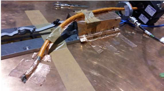
Figura 5.39: Apantallamiento del detector
