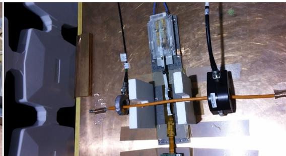
Figura 5.44: Cable de inyección perpendicular a cable kapton
