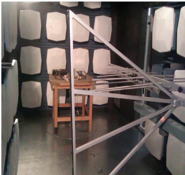
Figura 3.26: Configuración del ensayo para medición campo eléctrico
