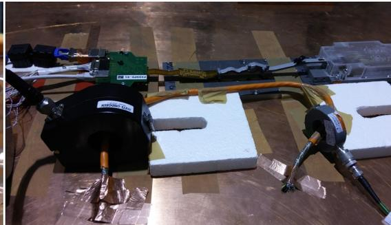
Figura 5.42: Cable inyección paralelo a cable cable Kapton
