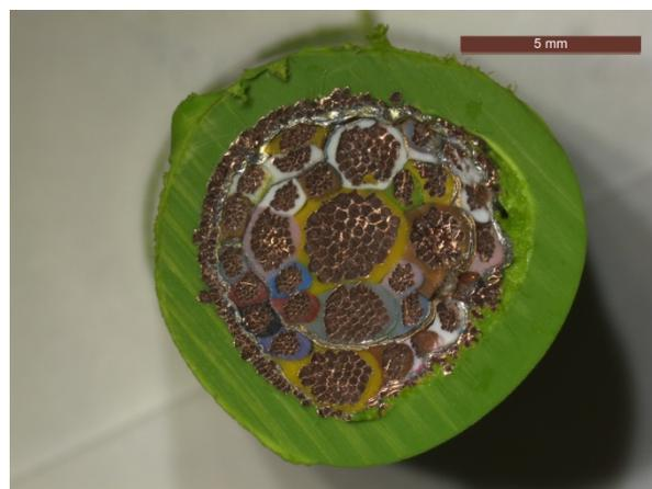
Figura 4.3: Disposición interna de los conductores
