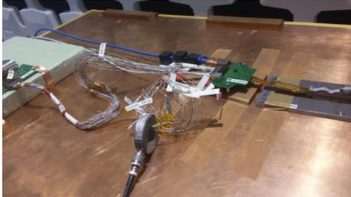
Figura 3.46: Configuración de medida sin CDN
