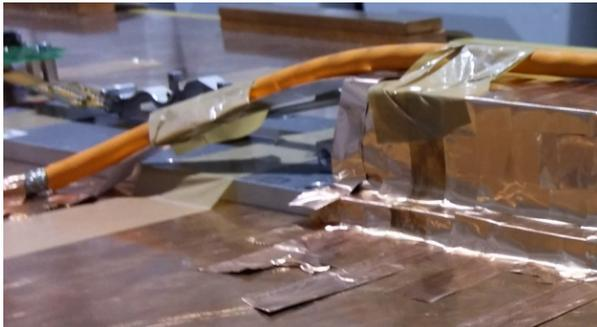
Figura 5.41: Detalle del apantallamiento
