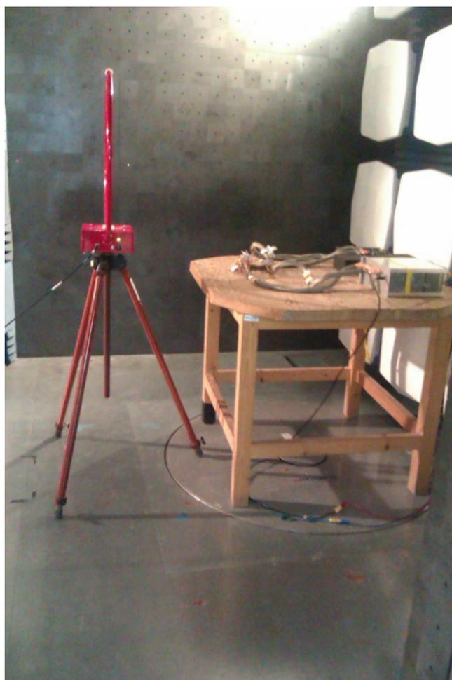
Figura 3.27: Configuración del ensayo para medición de campo magnético
