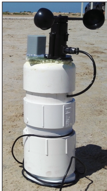
Figura 40 – Estructura central superior de la boya, donde se aloja la electrónica y se fijan los sensores externos.
