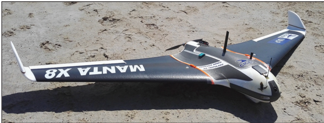
Figura 41 – UAV tipo ala delta utilizado en el proyecto SIMMA.
