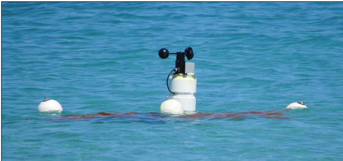
Figura 44 – Boya Davis colocada en la playa de El Tecolote (México) para captura de datos.
