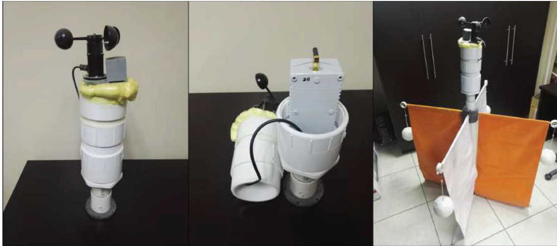
Figura 48 – Diseño y ensamble del primer prototipo contenedor del nodo sensor.
