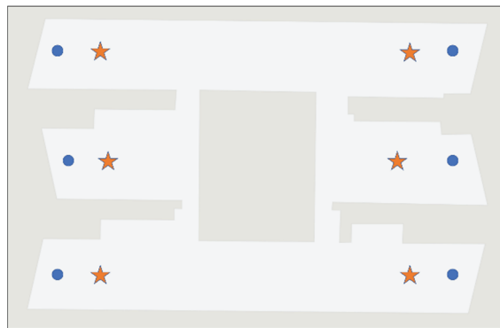
Figura 68 - Plano en 2D del edificio con la distribución de los nodos (círculos azules) y los enrutadores de la infraestructura pre-establecida (estrellas anaranjadas) para el protocolo WiFi.
