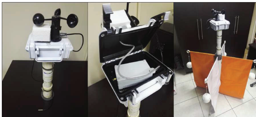
Figura 57 – Segunda versión de prototipo del envase para el nodo sensor y su montaje sobre la boya.
