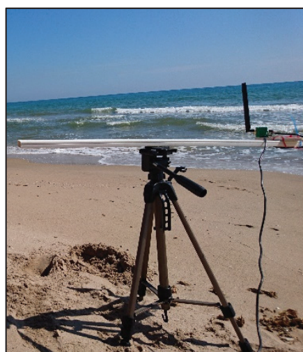
Figura 31 – Estructura sobre la que se colocó el receptor de LoRa.
