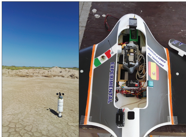
Figura 43 – Prueba inicial de vuelo. A la izquierda el nodo sensor puesto en tierra y a la derecha el UAV con el nodo de control colocado dentro.
