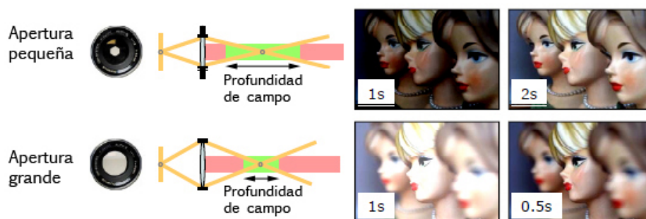
Figura 4.1: Variación de la profundidad de campo y de la exposición en función del tamaño de la apertura. Puede verse que para la apertura más pequeña la imagen presenta una exposición menor a pesar de emplear el mismo tiempo de exposición. También puede comprobarse cómo con la apertura más pequeña toda la imagen aparece bien enfocada al encontrarse dentro de la profundidad de campo, mientras que para la más grande sólo ocurre ésto con la parte central de la escena. (Adaptada de Hasinoff et al [7]).
