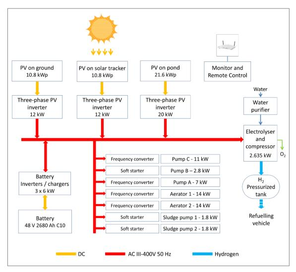
Figura 22. Esquema del sistema de energía
