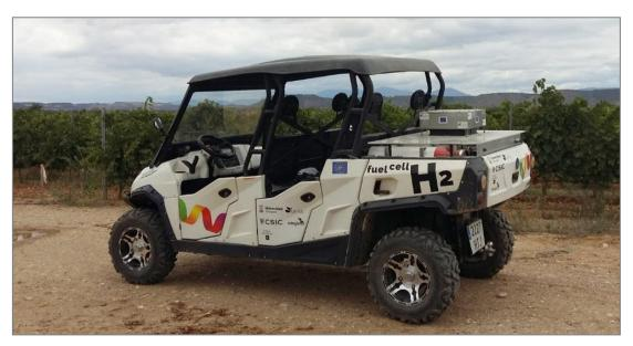
Figura 21. El vehículo operativo en campo, una vez incorporada la alimentación por hidrógeno y pila de combustible
