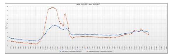
Figura 31. Gráfica de temperaturas ambiente y de los paneles del seguidor solar
