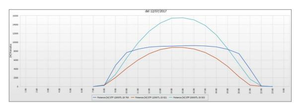
Figura 29. Gráficas de producción durante un día soleado (12/07/2017) de los tres campos fotovoltaicos: suelo (10 kWp), seguidor 10 (kWp) y flotante (20 kWp)
