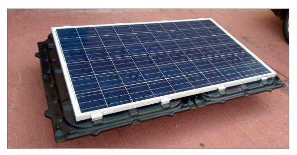
Figura 6. Primer prototipo del soporte flotante para paneles fotovoltaicos.
