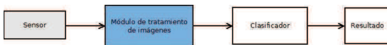
Diagrama A.1 Esquema general del clasificador en tiempo real. Los diferentes módulos son los que proporcionan la información al clasificador para generar un resultado.
