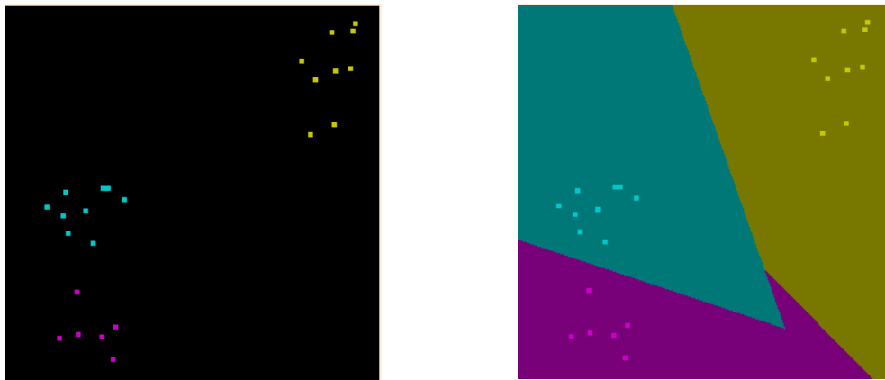
Figura 30 Ejemplo ilustrativo de como funciona el SVM, 3 clases y 2 características. Tomado de http://www.csie.ntu.edu.tw/~cjlin/libsvm/
