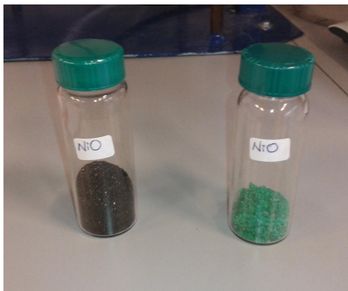
Figura 14.- Muestras del catalizador utilizado: a la izquierda el catalizador calcinado y a la derecha sin calcinar
