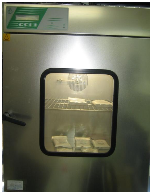
Foto 13. Incubador Eko Aparatura empleado durante el seguimiento de las microplacas
