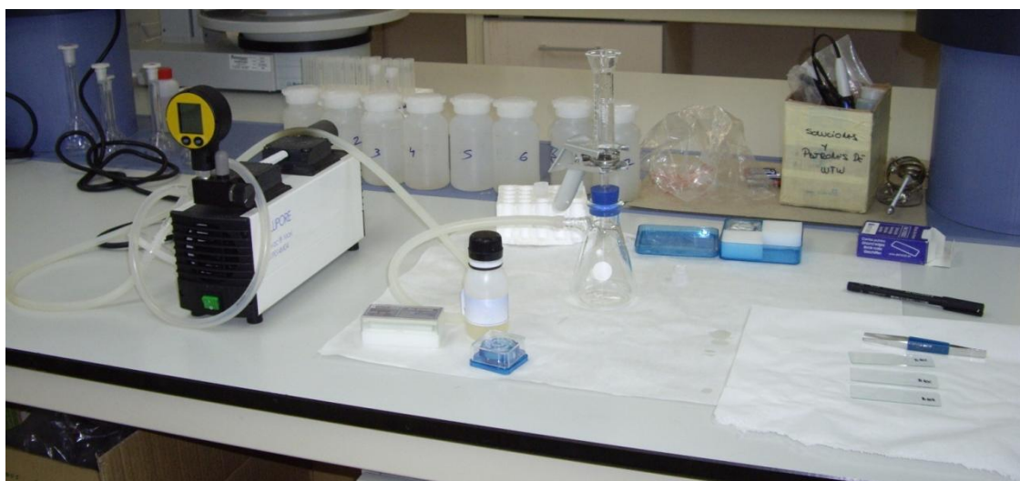
Foto 8. Bomba para filtrado y equipo de fijación del filtro de policarbonato para su posterior visualización
