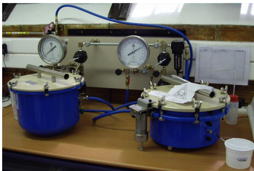
Foto 1. Cámaras de presión utilizadas para determinar la capacidad de campo y el punto de marchitez del suelo experimental.
