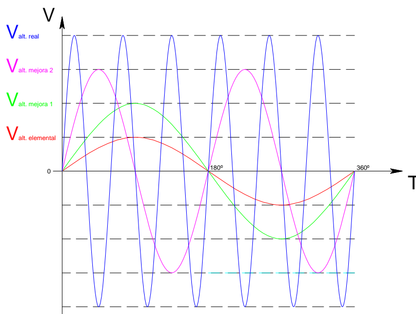
DIAGRAMA DE LA TENSION DE UNA DE LAS FASES DEL ALTERNADOR (SIN RECTIFICAR)
