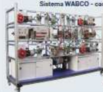
Sistema de frenos de aire comprimido Sistema WABCO - camión con remolque
