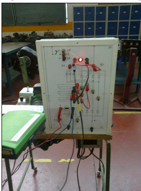
Foto 2. Conexiones en panel didáctico: 1 fase con puente de 1 diodo
