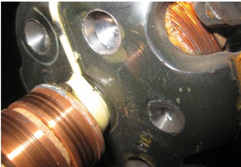
Ilustración 50 Equilibrado de rotor.
