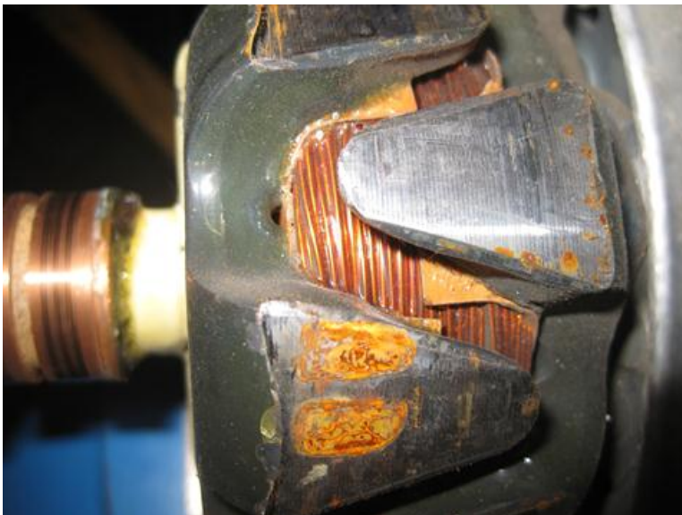
Ilustración 48 Detalle de bobinado del rotor.
