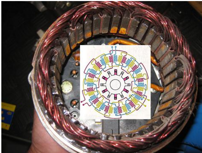
Ilustración 41 Estator vs su propio esquema.
