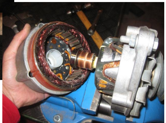
Ilustración 15 Evolución del proceso de maqueta de explosión de alternador.
