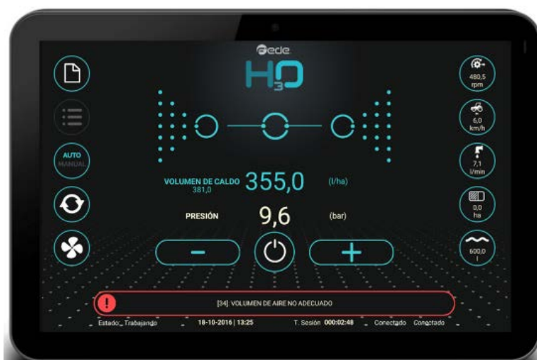
Figura 9: Pantalla de visualización de tratamiento en la cabina del tractor y sistema proactivo (Volumen de aire no adecuado).
