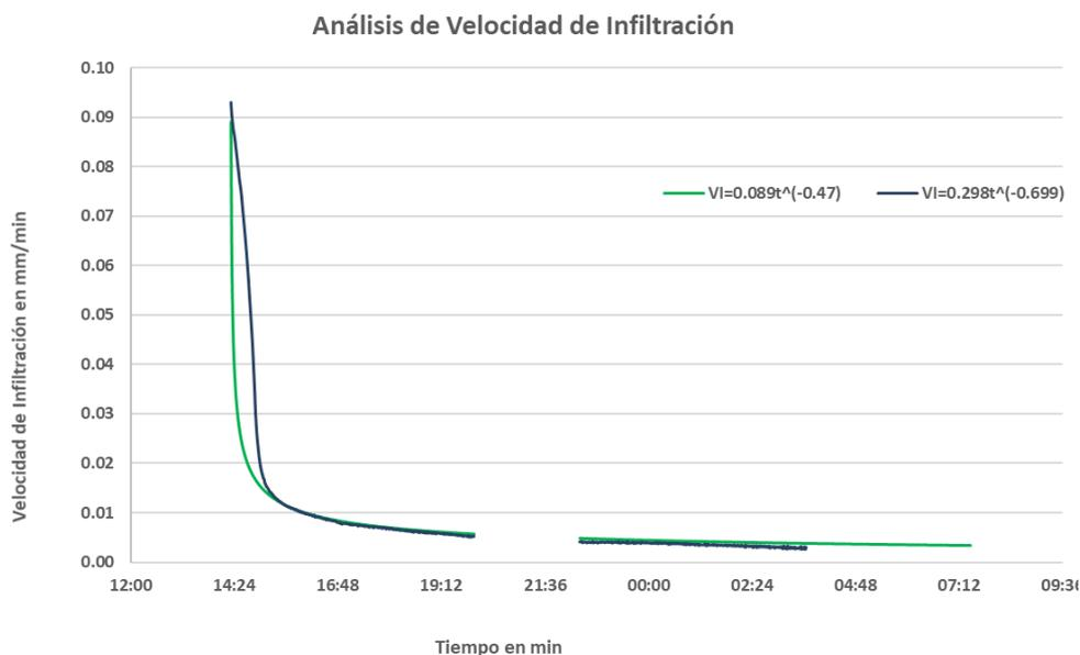
**Figura 4.** Curvas de los modelos de la velocidad de infiltración del lisímetro y Kostiakov.
