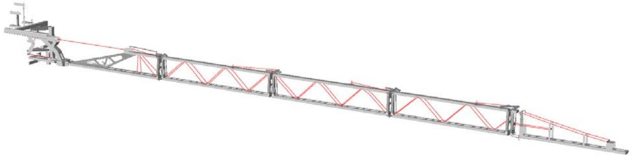
**Figura 1.** Modelo numérico de las barras del pulverizador hidráulico.
