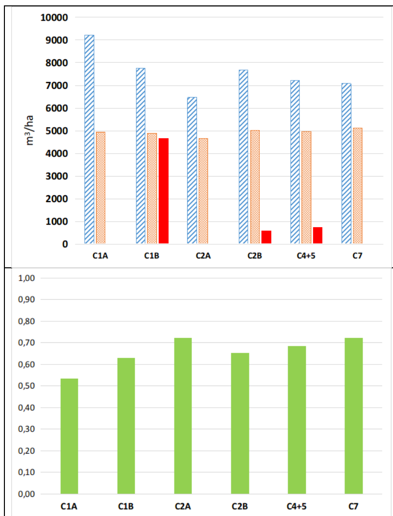
Figura 4. Superior: Valores sazonais da procura de água (■), afluência bruta total (▨), e afluência por bombagem (■), valores em m³/ha para cada SMC; Inferior: Eficiência global dos SMC, ratio (■).
