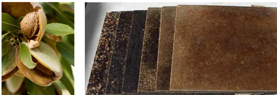
Figura 1. Cascos de almendra (exocarpo y mesocarpo) y tableros de partículas obtenidos sin adhesivos.
