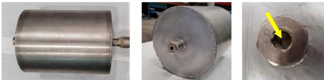
Figura 4.2. Detalles de una de las probetas con orificio calibrado
