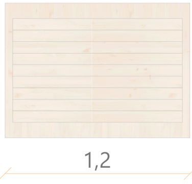
Rejillas de madera de pino situadas para los climatizadores de la planta superior (+0.00m)
