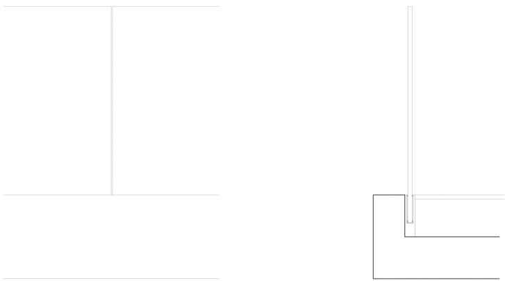
Barandilla de cristal, presente en el interior del edificio Realizada mediante una pieza metálica en forma de U en la que se inserta con un casquillo metálico el cristal doble de seguridad
