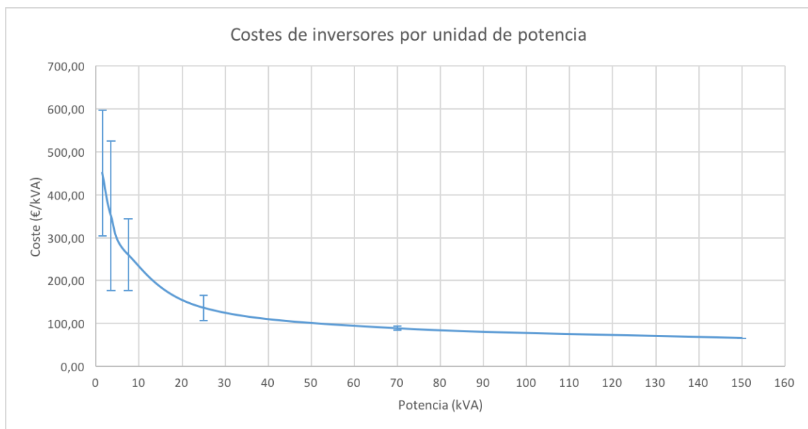
Figura 16: : Coste por unidad de potencia de inversores
