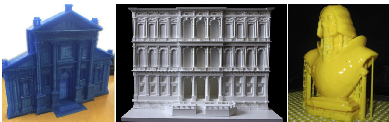
Figura 7: Figuras de Impresión 3D mediante FMD, SLD y SLA respectivamente. 25
