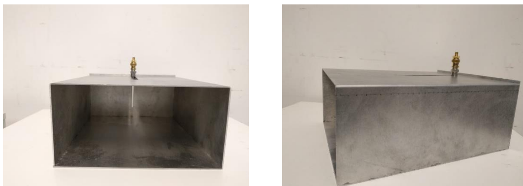
Figura 26: Adaptador coaxial-guía rectangular del diseño final
