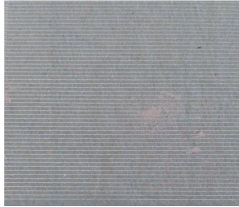
Figura 48: Vidrio con capa metálica completa (izda) y vidrio con FSS paso bajo de líneas de 100 \mu\text{m} dcha)
