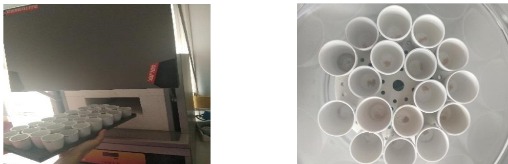
Ilustración 14: Puesta de crisoles con muestras en horno de mufla y cenizas obtenidas al final
