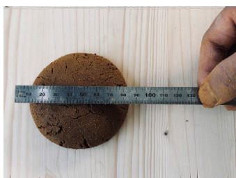
Fig 21. Test de la bola. Se lanza desde una altura determinada para comprobar su aplastamiento.
