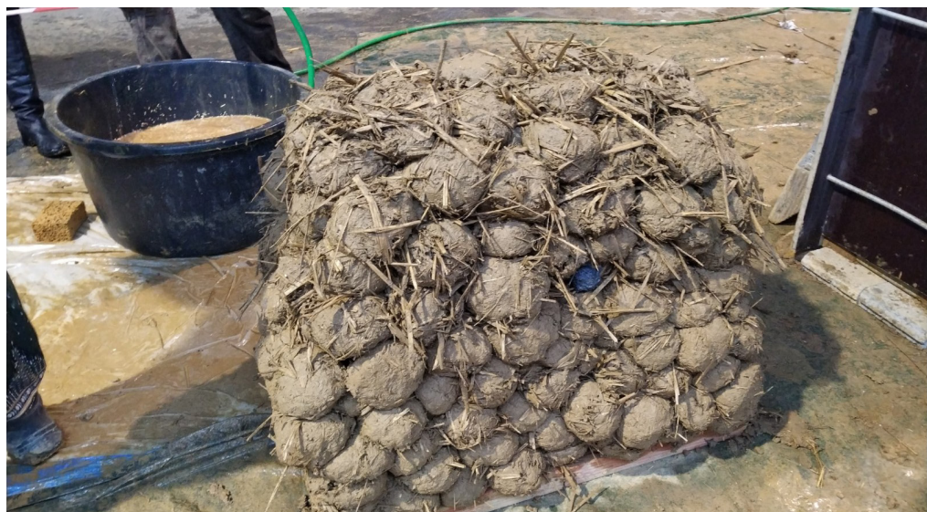
Fig 21. Test de la bola. Se lanza desde una altura determinada para comprobar su aplastamiento.
