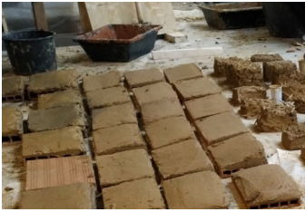
Fig 35. Revestimientos de tierra sobre piezas de ladrillo. Cuanta más cantidad de arena en la composición, más difícil es su aplicación pero se producen menos fisuras.
