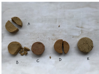
Fig 19. Test de la pastilla. Se comprueba la resistencia en seco de la pieza.
