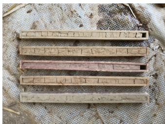
Fig 18. Test de retracción. Cuanta más agua en la mezcla mayor será esta.
