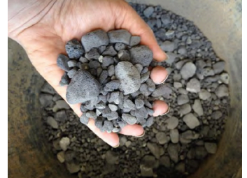
Fig 217. Grava de espuma de vidrio como aislante interior.
