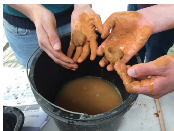
Fig 20. Test del hueco de la mano. Experiencia táctil del estado plástico y viscoso de la tierra.
