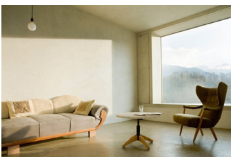
Fig 141. Planta primera. Zona de estar. Alféizar de la ventana como asiento para observar el paisaje y situado a la altura de la cocina, siendo el salón más grande en altura, Carpinterías en madera con una imprimación de caseína, aceite de linaza y cera de carnauba, como otras superficies de puertas y mobiliario. Superficie resultante dura y fácil de limpiar.
