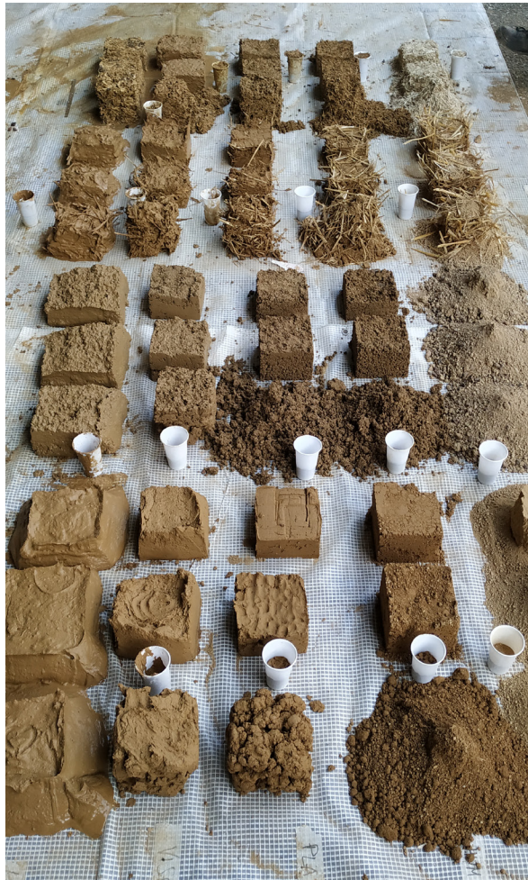
Fig 16. Mezcla con agua hasta obtener un estado plástico de la materia.
