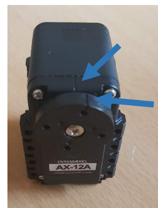
Figura 9 Motor: posición inicial incorrecta
