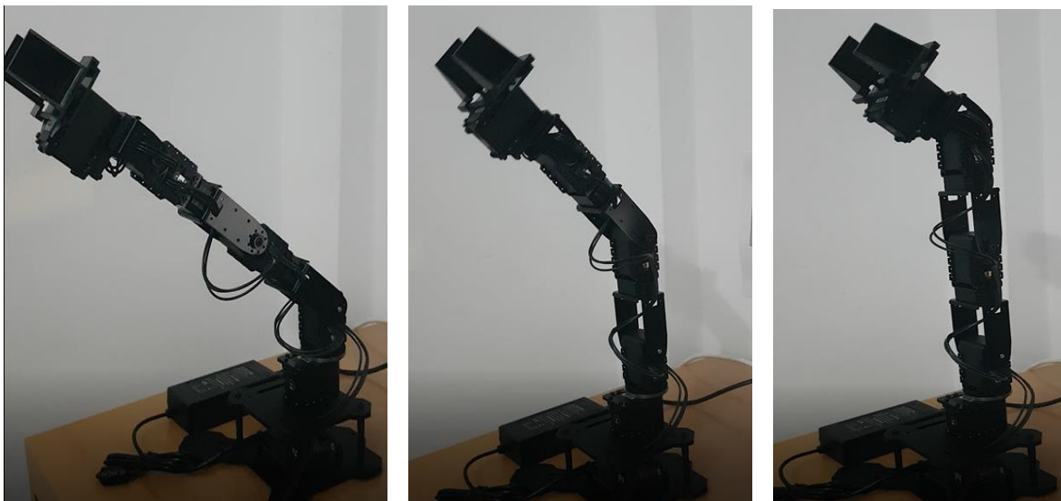
Figura 11 Fotos de la prueba realizada para comprobar su correcto montaje. Movimiento de la segunda, tercera y cuarta articulación (de izquierda a derecha).
