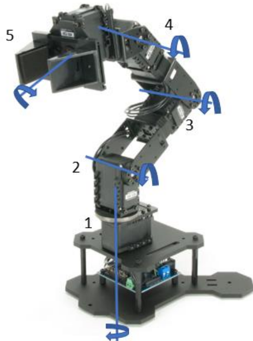
Figura 2 Tipos de movimiento de cada una de las articulaciones del PhantomX Pincher [5]
