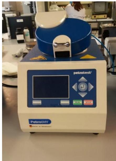
*Figura 10.* Equipo Oxidation Stability PetroOXY.
