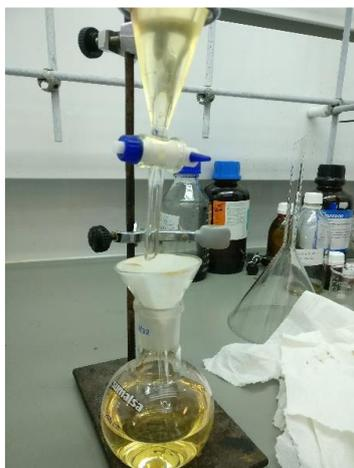
*Figura 12.* Filtración de la fase orgánica durante el proceso de extracción.
