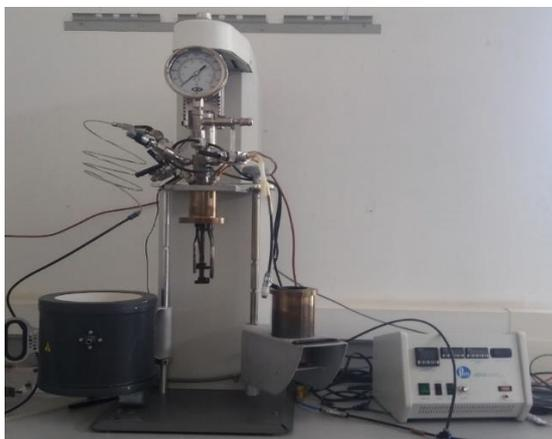
*Figura 8.* Reactor tipo Batch usado para la despolimerización de la lignina.
