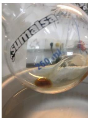
*Figura 13.* Fase orgánica restante en el balón después de la evaporación del acetato de isopropilo.
