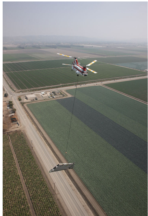
Fig.75 Transporte de un ala del boeing 747 con helicóptero.
