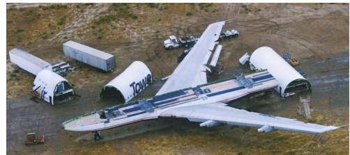
Fig.73 El Boeing 747 fue demontado y cortado para su transporte.
