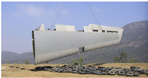
Fig.76 Las piezas se colocan en una cama de neumáticos hasta su posterior levantamiento con grúa.
