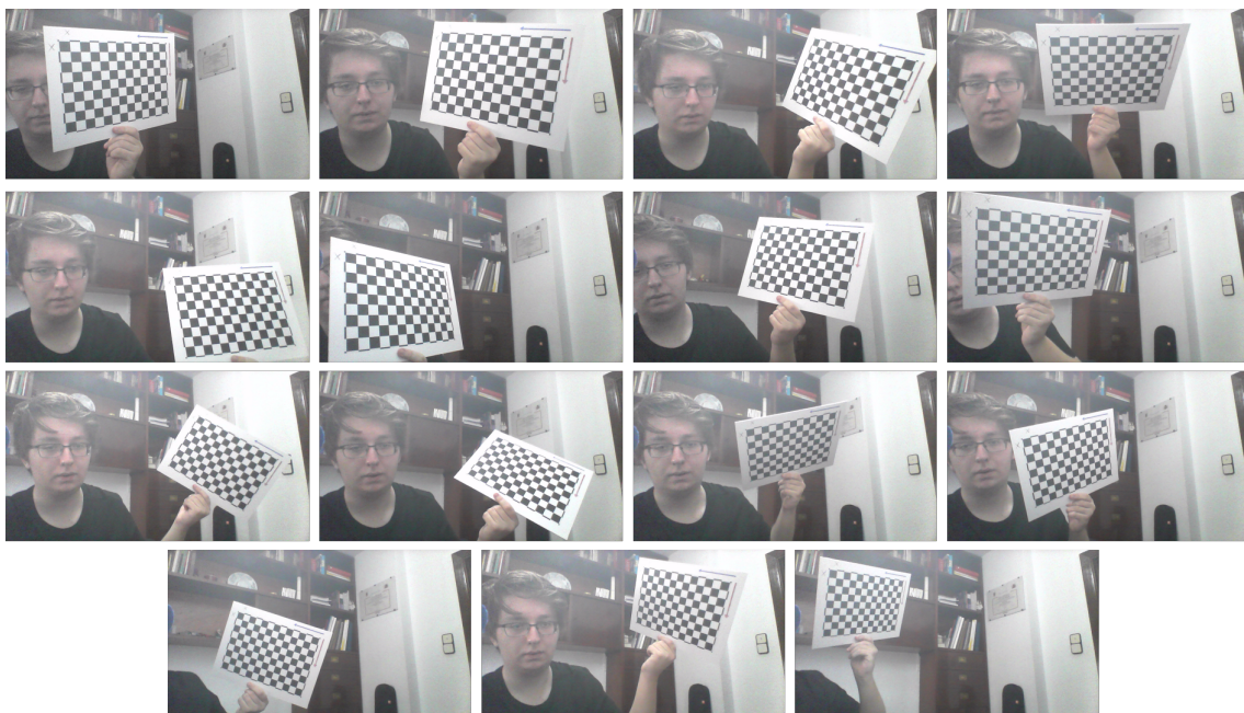
Figura B.4: Conjunto de imágenes realizadas sin condiciones similares en cuanto a cercanía y rotación sobre la normal del mismo; aunque la condición de distribuir el patrón por el plano imagen se mantiene.
