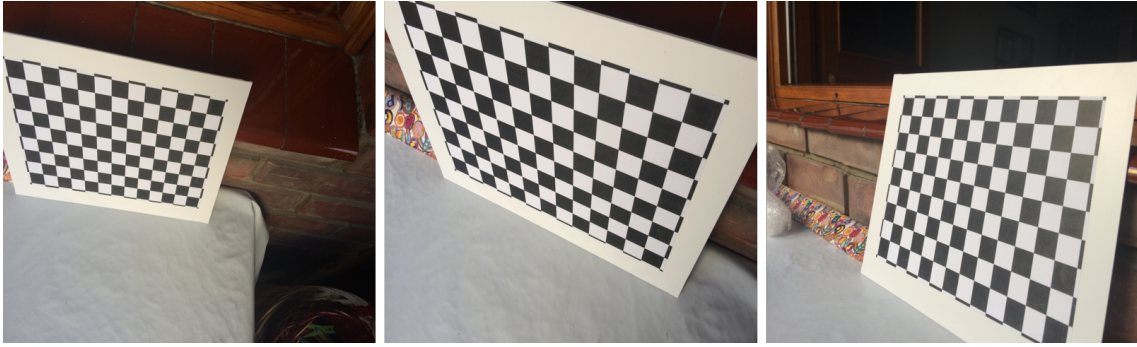
Figura 1.2: Diferentes vistas de un patrón de calibración.
