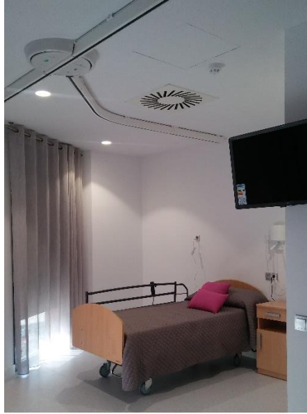
Ilustración 11. Cama articulada con guía para grúa de transporte. Elaboración propia. Fuente: Fundación DFA.
