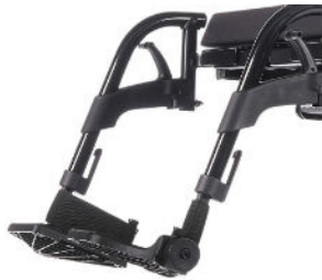
Figura 4.3 Vista de la unión asiento con los reposapiés
