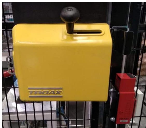
Figura 4.38: Sistema seguridad puerta
