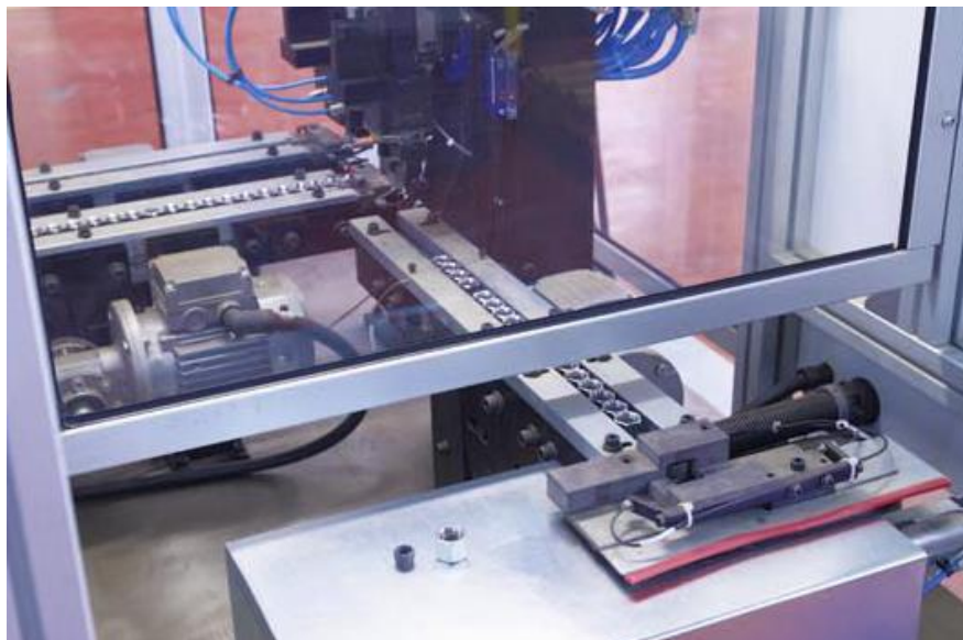
Figura 3.2: Máquina semiautomática racor DIN 2353
