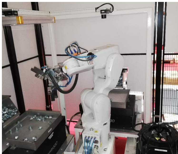
Figura 25: Sistema de montaje de prensa automática de racores
